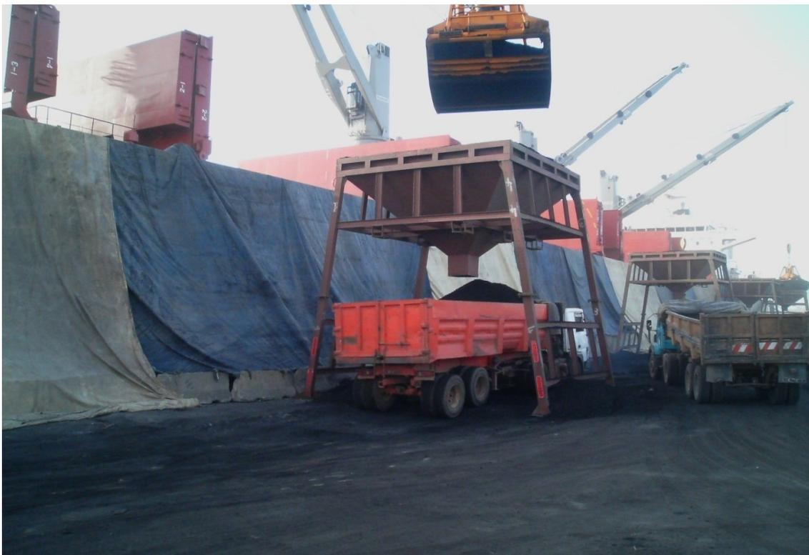
Par ailleurs le produit se déverse souvent aux alentours de la trémie lorsque la benne preneuse est remplie. Ainsi la pelle mécanique intervient pour faire du raclage. Ce qui évite l'encombrement du quai tout en facilitant l'accès aux camions. Le clinker entassé à coté permettra éventuellement de remplir les camions non pleins.
