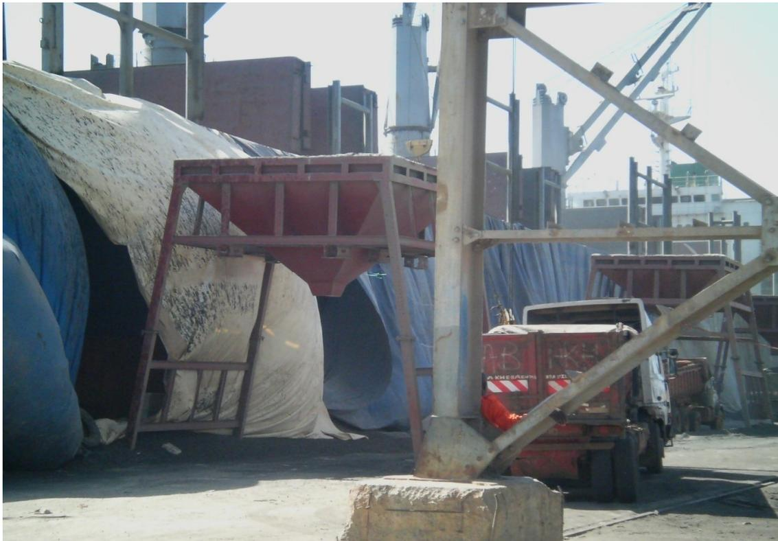
Après cette tâche, les trémies sont installées le long du navire devant chaque cale en corrélation avec les mâts de charge. Ces mâts de charge prennent le clinker dans les cales à l'aide des bennes preneuses qu'on y accroche.
