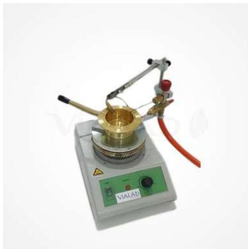
Image 4 : Appareil de mesure avec récipient ouvert
