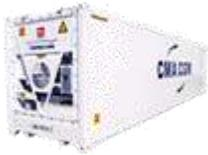
Ce type de conteneurs est utilisé pour le transport sous température dirigée. Il est équipé d'un moteur électrique permettant de maintenir une température à l'intérieur du conteneur.
