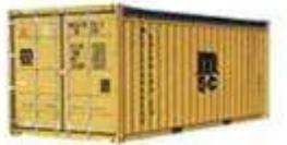
Les caractéristiques des conteneurs Open Top sont identiques à celle des DRY mise à part qu'il est dépourvu d'un toit rigide et qu'il peut être équipé d'une couverture mobile. Ce type de conteneurs est utilisé pour le transport de produits manufacturés lourds et / ou volumineux, permettant ainsi de charger les produits à l'aide d'une grue.
